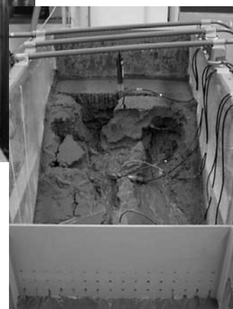
写真⑤ 降雨による斜面崩壊実験
