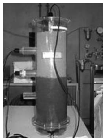
写真④ 土層への水の浸潤モニタリング
