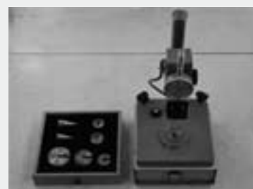
土の判別・分類のためのフォールコーン試験装置一式
